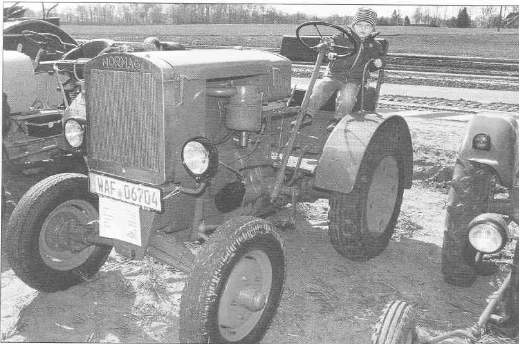
Charakteristisch für den NG 22 ist der breite, gepolsterte Doppelsitz. Die Leistungsangaben für den Motor schwanken zwischen 20 und 22 PS. Foto: Wobser
