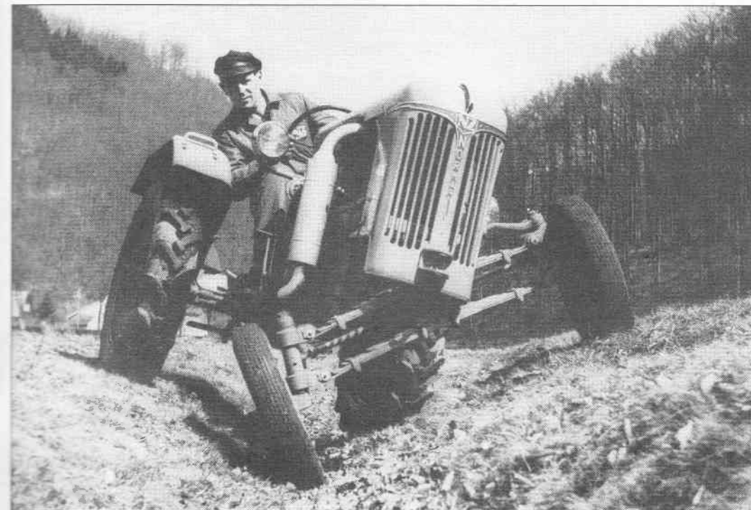
Ein im eigenen Werk gefertigter Vorkammer-Diesel vom Typ BM 15 L mit 1180 cm 3 Hubraum ist für den Antrieb des Faktor I zuständig. Auch das Fünf-Gang-Getriebe stammt aus Normag-Produktion.
